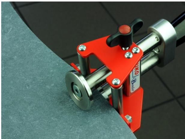
Mittels Skala wird die Höhe der Aufkantung eingestellt, die Flügelschraube wieder fixiert und danach das Blech zwischen den Falzrädern eingeführt, wobei die schräg gestellte Biegescheibe in Richtung Aufkantung zeigt.
