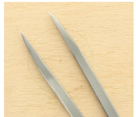
Mit gehärteten Spitzen zum Anreißen
