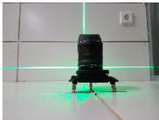
Bessere Sichtbarkeit der Laserlinie im Innenbereich durch die grüne Laserdiode.
